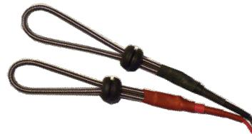
**CABLE DE CONECTOR DIN PARA ELECTRODO DE REGISTRO AGUJAS DE EMG DE TRES PINES**
